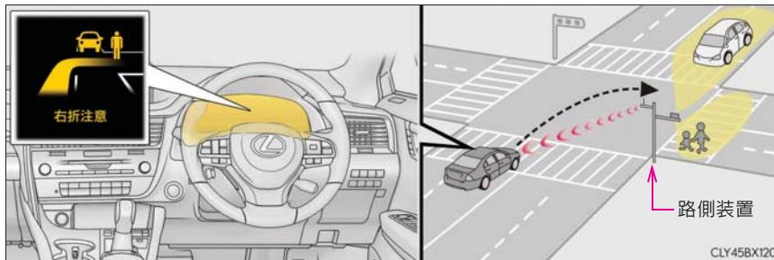
ITS Connect は、道路に設置された DSSS<sup>※</sup> 用路側装置や通信機を搭載した車両と無線通信することで、見通しが悪い交差点の交通状況などの情報を受信します。
