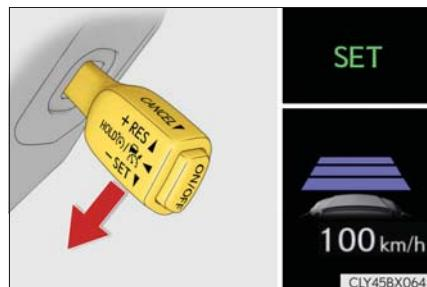
車速が約 50km/h 未満、かつ先行車がない状態でレバーを操作したときは、設定速度が約 50km/h にセットされます。
