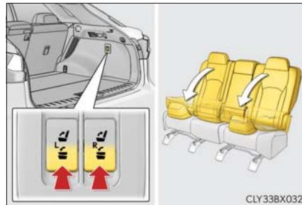
リヤ席スイッチ操作時：背もたれがうしろに倒れている場合は、背もたれを直立位置にし、再度スイッチを押してください。
