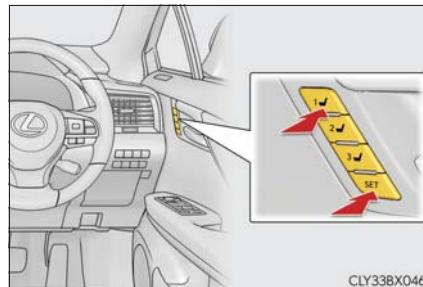
助手席側★を登録するときは、助手席をお好みの位置に調整し、助手席側のスイッチで手順**4**の操作を行うと、助手席のシート位置が登録できます。
