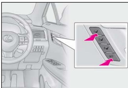
助手席側★を登録するときは、助手席をお好みの位置に調整し、助手席側のスイッチで手順 4 の操作を行うと、助手席のシート位置が登録できます。
