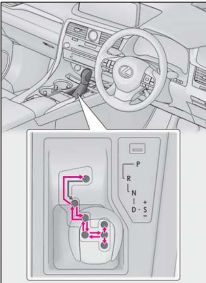
← パワースイッチがONモードの状態、ブレーキペダルを踏んだまま操作します。
