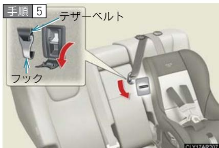
フタを開けて、トップテザーアンカーにフックを固定し、テザーベルトを締める
