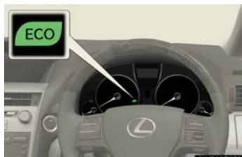
環境にやさしいアクセル操作（エコ運転）中は、エコドライブインジケーターランプが点灯します。アクセルの踏みすぎなど、エコ運転の範囲をこえた場合には、エコドライブインジケーターランプが消灯します。
