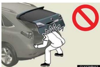
● 半開状態で使用すると、バックドアが落ちて重大な傷害を受けるおそれがあります。とくに傾斜地では、平坦な場所よりもバックドアの開閉がしにくく、急にバックドアが開いたり閉じたりするおそれがあります。必ずバックドアが全開で静止していることを確認して使用してください。
