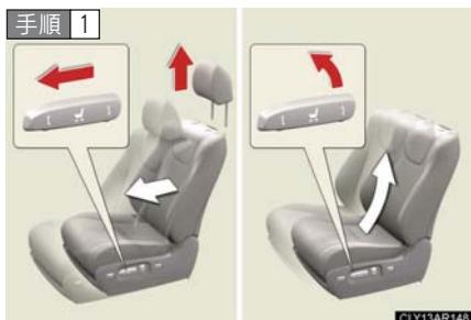
フロントシートのヘッドレストを取りはずし (→P. 87)、シート全体をいちばん前および上まで移動させる
