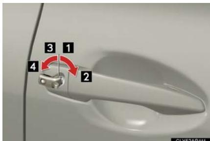
メカニカルキー（→P. 43）を使って操作します。（運転席ドアのみ）
