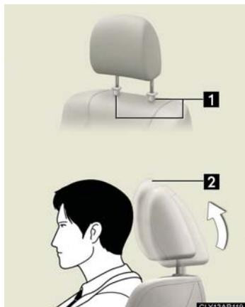
シートバックへの衝撃が弱い場合でもアクティブヘッドレストが作動することがあります。なお、解除ボタンを押さずにヘッドレストを無理に押し上げると、ヘッドレストの構造部品が出てきますが、故障ではありません。
