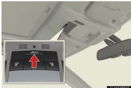
“パワー”スイッチを OFF にし、侵入センサー OFF スイッチを押す
