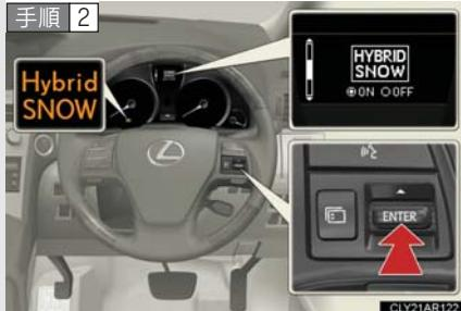
ENTER スイッチを押して、ON に切りかえると Hybrid SNOW 表示灯が表示されます。
