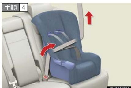
チャイルドシートをリヤシートに押さえ付けながら、肩部ベルトを巻き取らせる
