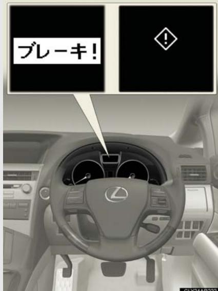
衝突の危険性があると検知したとき、“ピーピーピー”とブザー音が鳴り、PCS 警告灯が点滅し、マルチインフォメーションディスプレイに注意喚起表示が出ます。さらに衝突の可能性が高い場合には、“ビピピピ…”とブザー音が鳴り、PCS 警告灯が点滅、衝突警告表示を出し、回避操作をうながします。
