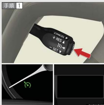
ON-OFF スイッチを押して、システムを ON にする
