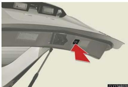
スイッチを押すとブザーが鳴り、非常点滅灯が2回点滅し、バックドアが自動で閉まります。
