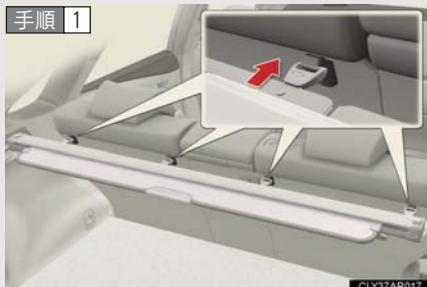
サブカバーのクリップをリヤシートのホルダーに取り付ける。
