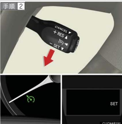
希望の速度まで加速／減速し、レバーを下げる設定する
