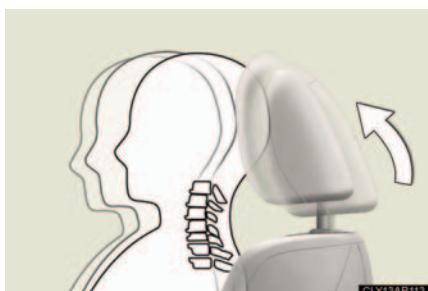
追突の衝撃によって、乗員の腰がシートバックを押すことによってヘッドレストが少し斜め上方に動き乗員のむち打ち傷害軽減に貢献します。
