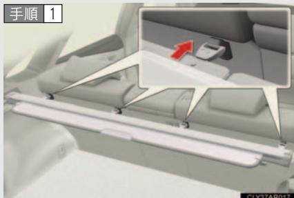
サブカバーのクリップを取り付ける。
