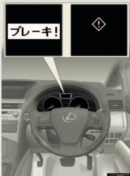
衝突の可能性があると検知したとき、“ピーピーピー”とブザー音が鳴り、PCS 警告灯が点滅し、マルチインフォメーションディスプレイに注意喚起表示が出ます。さらに衝突の可能性が高い場合には、“ビピビ…”とブザー音が鳴り、PCS 警告灯が点滅、衝突警告表示を出し、回避操作をうながします。
