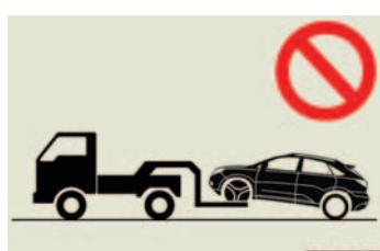
AWD 車：前輪または後輪のいずれかの車輪が地面に付いた状態でけん引しない。モーターから電気が発電され、故障や破損の状態によっては漏電による火災のおそれがあり危険です。
