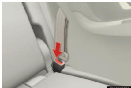
解除ボタンを押してバックルをはずし、ベルトをいっぱいまで巻き取らせると、チャイルドシート固定機構が解除されます。
