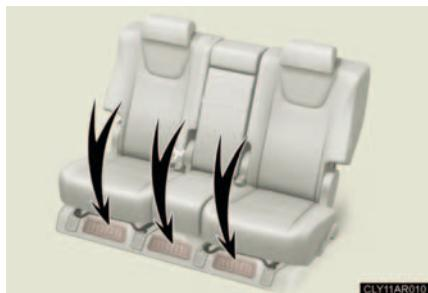
リヤシート下部には、駆動用電池冷却用の吸入口があります。吸入口をふさいだりすると、駆動用電池の過熱や出力低下の原因となります。
