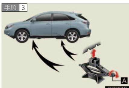
ジャッキの A 部を手でまわして、ジャッキ溝をジャッキセット位置にしっかりとかける
