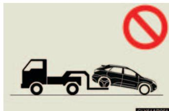
2WD 車：前輪が地面に付いた状態で後ろからけん引しない。モーターから電気が発電され、故障や破損の状態によっては漏電による火災のおそれがあり危険です。
