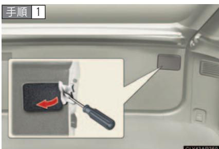
バックドアを開け、カバーの切り欠きにマイナスドライバーなどを差し込んで取り外す。
