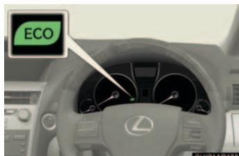
環境にやさしいアクセル操作（エコ運転）中は、エコドライブインジケーターランプが点灯します。アクセルの踏みすぎなど、エコ運転の範囲をこえた場合には、エコドライブインジケーターランプが消灯します。
