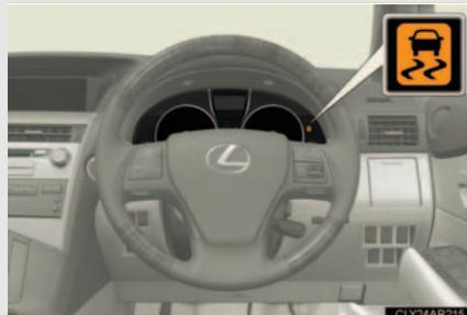
車両が完全に停止している状態で、更にブレーキペダルを踏み込むとヒルスタートアシストコントロールは作動します。
