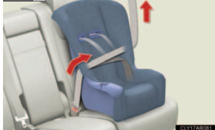
チャイルドシートをリヤシートに押さえ付けながら、肩部ベルトを巻き取らせる
