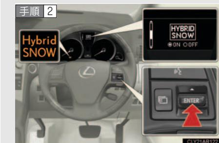
ENTER スイッチを押して、ON に切りかえると Hybrid SNOW 表示灯が表示されます。
