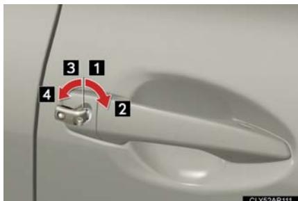
メカニカルキー（→P. 44）を使って操作します。（運転席ドアのみ）
