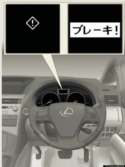
衝突の可能性があると検知したとき、“ピーピーピー”とブザー音が鳴り、PCS 警告灯が点滅し、マルチインフォメーションディスプレイに注意喚起表示が出ます。さらに衝突の可能性が高い場合には、“ビビビ…”とブザー音が鳴り、PCS 警告灯が点滅、衝突警告表示を出し、回避操作をうながします。
