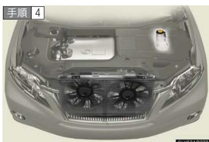
ハイブリッドシステムが十分に冷えてから、冷却水の量や冷却水もれを点検する
