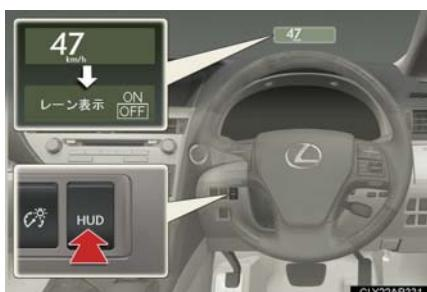
HUD メインスイッチを 2 秒以上押すと、レーン表示の ON/OFF 切り替え画面に移行します。HUD メインスイッチを押すごとに ON/OFF は切りかわります。
