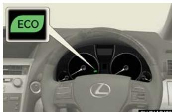
環境に配慮したアクセル操作（エコ運転）中は、エコドライブインジケーターランプが点灯します。アクセルの踏みすぎなど、エコ運転の範囲をこえた場合には、エコドライブインジケーターランプが消灯します。（→P. 182）
