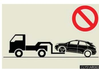
AWD 車：前輪または後輪のいずれかの車輪が地面に付いた状態でけん引しない。モーターから電気が発電され、故障や破損の状態によっては漏電による火災のおそれがあり危険です。
