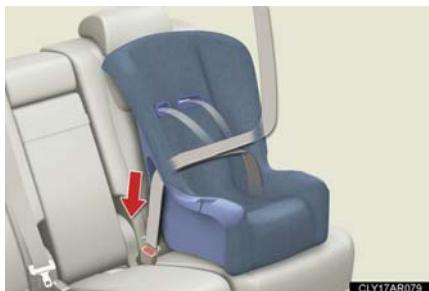
チャイルドシートにシートベルトを取り付け、プレートをバックルに“カチッ”と音がするまで差し込む。ベルトがねじれていないようにする。
