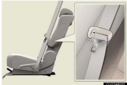
シートベルトをリヤシート側面のポケットに格納する
