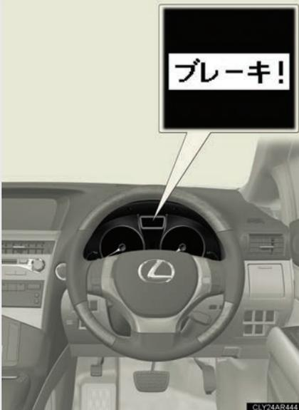
衝突の可能性が高い場合には、“ピピピ…”とブザー音が鳴り、PCS 警告灯が点滅、衝突警告表示を出し、回避操作をうながします。
