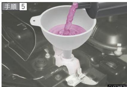
冷却水が不足している場合は、冷却水を補給する（→P. 299）
