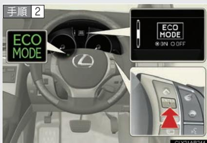
ENTER スイッチを押して、ON に切りかえると ECO MODE 表示灯が表示されます。
