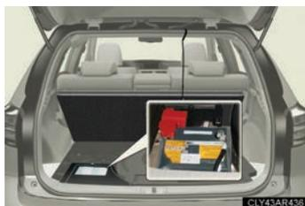
この車両の補機バッテリーはラゲージルーム下部（助手席側）のカバー内にあり、エンジンルームには搭載されていません。（補機バッテリーはバッテリー液の補充が必要ないタイプのため、バッテリー液量などの点検は不要です）
