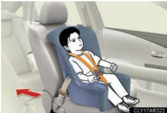
● やむを得ず助手席に前向きにチャイルドシートを取り付ける場合には、助手席シートをいちばんうしろに下げて取り付けてください。助手席 SRS エアバッグはかなりの速度と力でふくらむので、お守りいただかないと、重大な傷害を受けたり、最悪の場合死亡につながるおそれがあります。
