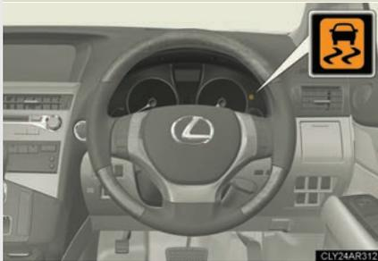
車両が完全に停止している状態で、更にブレーキペダルを踏み込むとヒルスタートアシストコントロールは作動します。
