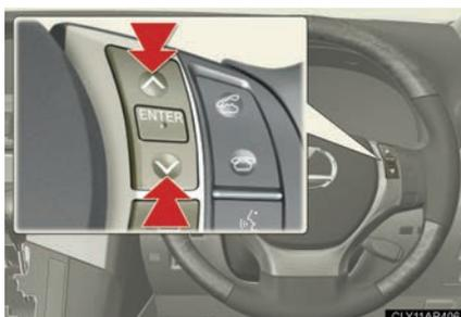
△ Vスイッチを押してエネルギーモニターを表示させる。
