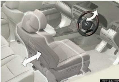
降車時：以下のすべての操作を行ったとき、ハンドルが最上段・最前方に移動、運転席シートが後方に移動（オートアウェイ機能）
