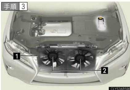
ハイブリッドシステムが十分に冷えてから、ラジエーターコア部（放熱部）やホースなどからの冷却水もれを点検する
