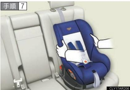
取り付けたチャイルドシートを前後左右にゆすり、確実に固定されていることを確認する
