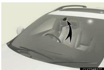
● 雨滴感知センサーが雨滴量を判定します。光学センサーを使用しているため、フロントガラスに朝日や夕日が断続的にあたるときや、虫などで汚れたときに、正しく作動しないことがあります。
