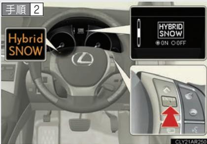
ENTER スイッチを押して、ON に切りかえると Hybrid SNOW 表示灯が表示されます。
