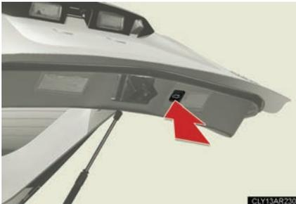
スイッチを押すとブザーが鳴り、非常点滅灯が2回点滅し、バックドアが自動で閉まります。
