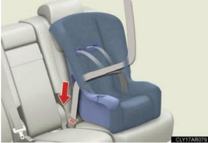
チャイルドシートにシートベルトを取り付け、プレートを保ックルに“カチツ”と音がするまで差し込む。ベルトがねじれていないようにする。
