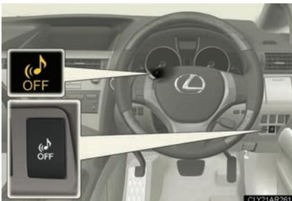
消音するには、“パワー”スイッチが ON モードのとき、スイッチを押す
