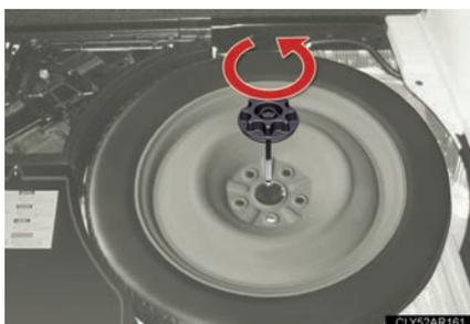
デッキボードを持ち上げてから応急用タイヤカバーを取りはずす。留め具をはずし、応急用タイヤを取り出す
