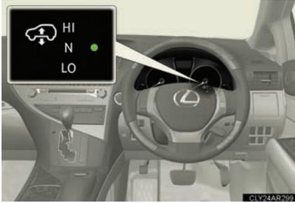
インジケーターが点灯し、選択中のモードを表示します。選択したモードへ移行中はインジケーターが点滅します。
