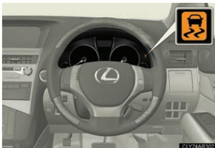
車が横すべりしそうなとき、タイヤが空転したときは、VSC・TRCの作動を表示するために、スリップ表示灯が点滅します。
