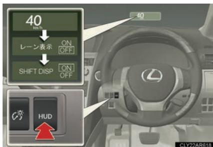
HUD メインスイッチを長押しすると、各表示の ON/OFF 切り換え画面に移行します。
