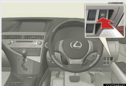
スイッチを押してヘッドランプを洗淨する
