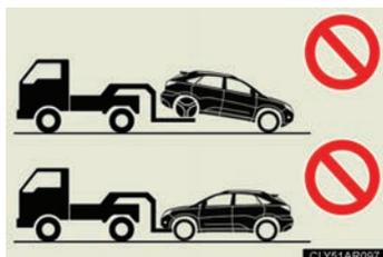
必ず前輪を持ち上げるか、4 輪とも持ちあげた状態で運搬してください。前輪が地面に着いた状態でけん引すると、駆動系部品が破損したり、モーターが回転することにより発電され、故障や破損の状態によっては火災が発生するおそれがあります。
