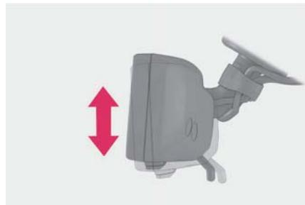
鏡面ミラーモードに切りかえて、インナーミラー本体を持って、上下方向に調整する
