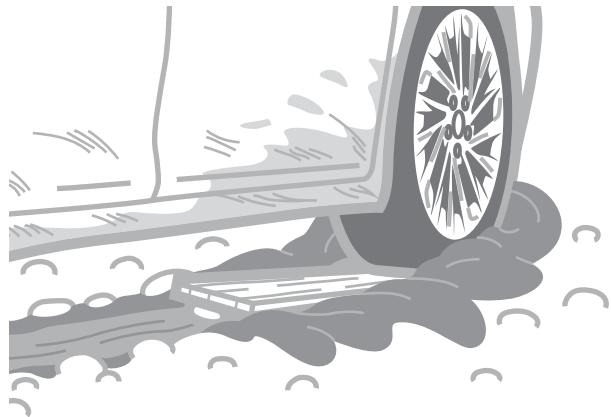
段差や凸凹のある荒れた路面を走行すると、タイヤの空気が抜けることがあります。タイヤの空気が抜けると、タイヤのクッション性能が低下し、車両に損傷を与えるおそれがあります。
