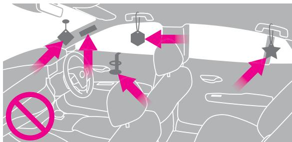
SRS エアバッグが展開する次のような部位に何かを付けたり、置いたり、かけたりしないでください。SRS エアバッグが正常に作動するのをさまたげ、システムが作動しない、または誤つて作動するおそれがあります。
