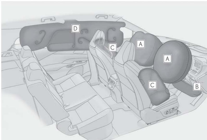
**A** フロント SRS エアバッグ（運転席 SRS エアバッグ／助手席 SRS エアバッグ）
