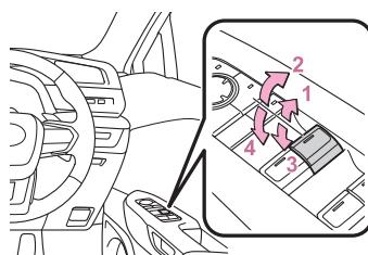
4 パワーウィンドウスイッチを完全に押します。
