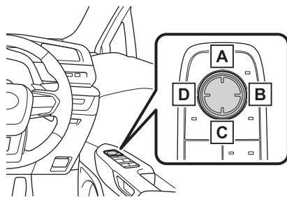
2 ミラーの鏡面を調整するにはスイッチを押します。
