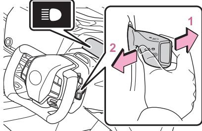
1 ランプが点灯した状態で、レバー前方に倒します。
