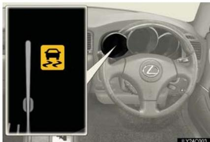
車両が横滑りしそうになったとき、または後輪が空転したときは、VSC、TRCの作動を表示するためにスリップ表示灯が点滅します。
