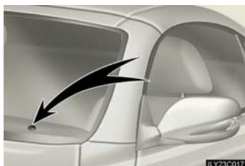
センサーの上に物を置いたり、センサーを塞ぐようなものをウインドウガラスに貼らないでください。周囲からの光が遮られると、自動点灯・消灯機能が正常に動かなくなります。
