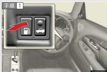
給油口オープナーを押して給油口を開ける
