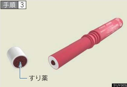
先端のフタを取りはずし、すり薬と発炎筒の先端をこすり、着火させる
