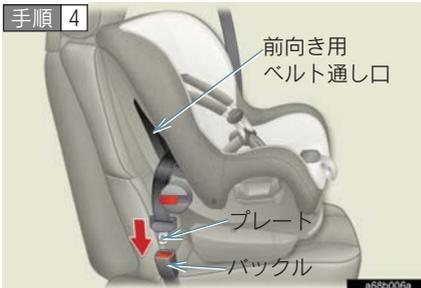
**手順 3**の反対側の前向き用ベルト通し口からシートベルトを引き出し、プレートをバックルに差し込む
