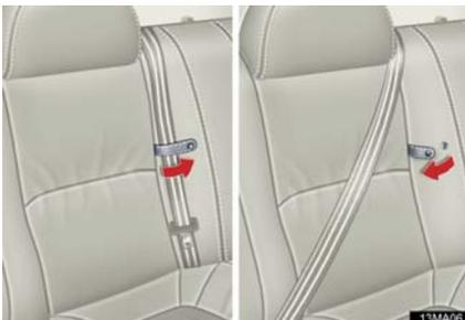
リヤシートベルトを使用しないときはホルダーで固定し、使用するとき必ずホルダーからベルトをはずしてください。
