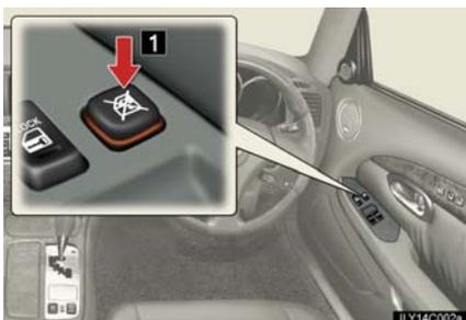
1 スイッチを押して助手席のドアガラスを作動不可にする
