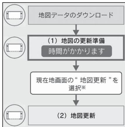
※ “地図更新” を選択しなかった場合、次回エンジンスイッチ<パワースイッチ>をアクセサリモードまたはイグニッション ON モード< ON モード>時に地図更新を行います。
