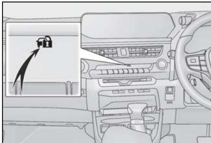
エンジンスイッチを OFF になると、システムの作動を知らせるためにセキュリティ表示灯が点滅します。
