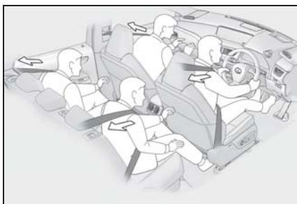
前方・側方から強い衝撃を受けたとき、シートベルトを引き込むことで適切な乗員拘束効果を確保します。
