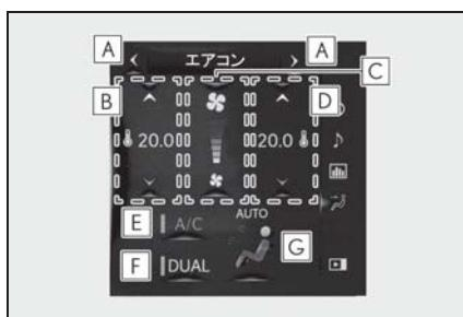
**A** ステアリングヒーター★／シートヒーター★／シートベンチレーター★操作画面を表示する
