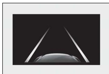
システムが白（黄）線または走路※<sup>2</sup>を認識していることを示しています。車両が車線から逸脱した場合、逸脱している側の白線表示が橙色で点滅します。
