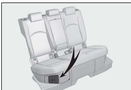
リヤシートの下（右側）には、駆動用電池冷却用の吸入口があります。吸入口をふさいだりすると、駆動用電池の出入に制限がかかり、出力低下の原因となります。
