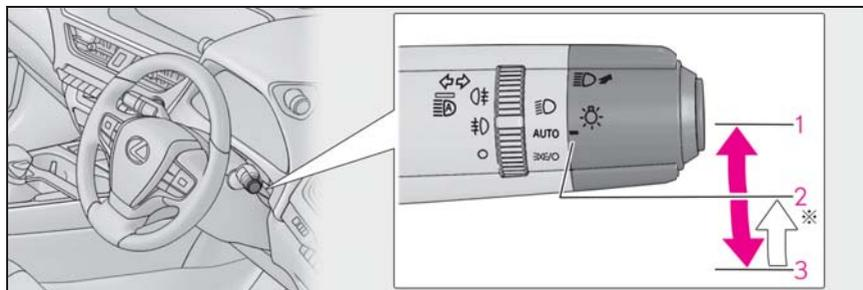
※ スイッチを **3** 点滅/O の位置へ操作し手を離すと、自動的に **2** AUTO の位置へ戻ります。
