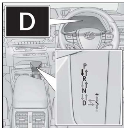
← パワースイッチがONの状態、ブレーキペダルを踏んだ状態
