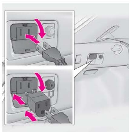
アース線のある電気製品を使用するときは、アース端子付きのコンセントを使用し、アース線をアース端子に接続してください。また、接地極付きプラグのある電気製品を使用するときは、市販の変換アダプターを使用してアース線をアース端子に接続してください。
