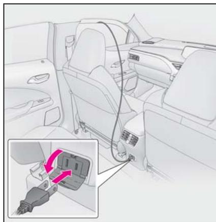
電気製品が接続されていることがわかるように窓からコードを出すことをおすすめします。その場合は、図で示すように接続されたコードにたるみをもたせ、異常な張りが発生しないようにしてください。
