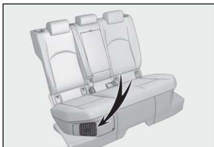
リヤシートの下（右側）には、駆動用電池冷却用の吸入口があります。吸入口をふさいだりすると、駆動用電池の入出に制限がかかり、出力低下の原因となります。
