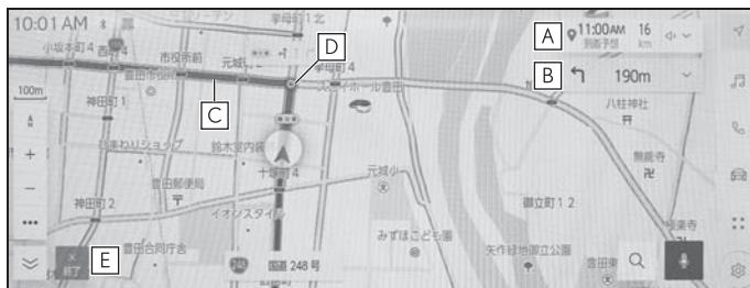
**A** 自車位置から目的地までの距離と到着予想時刻が表示されます。ルートからはずれた場合は、到着予想時刻は表示されず、目的地までの直線距離が表示されます。
