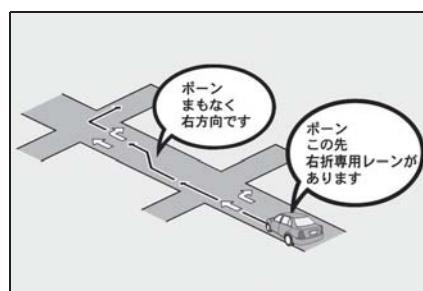
直進する交差点に右折（左折）専用レーンがある場合、その交差点に近づくと「この先 右折（左折）専用レーンがあります」と音声案内されます。目的地案内中で、右折（左折）する交差点では右折／左折専用レーン案内はされません。この場合は「ポン まもなく 右方向（左方向）です」と音声案内されます。
