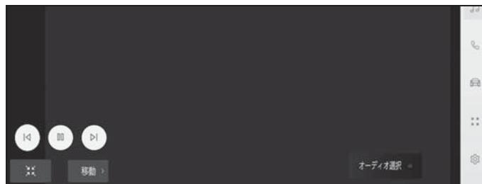
[◀]：再生中のファイルの先頭から再生します。ファイルの先頭のときは、前のファイルの先頭から再生します。タッチし続けると、映像を早もどしします。手を離すと、その位置から再生します。
